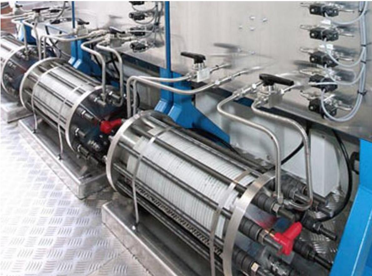
Pertanto, per produrre idrogeno da elettrolisi dell'acqua serve un impianto di produzione (che comprende un certo numero di celle elettrolitiche, circuiti idraulici e serbatoi) ed energia elettrica. Con i rendimenti degli impianti attuali occorrono 55 chilowattora di energia elettrica per ottenere 1 chilogrammo di idrogeno. In futuro, migliorando i rendimenti, potrebbero bastare 45 chilowattora.
